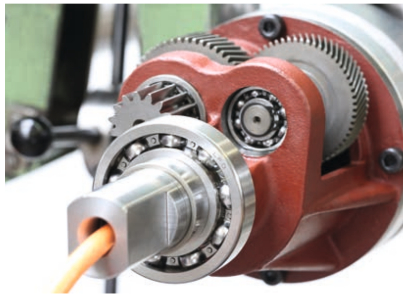
In den Trommelmotoren kommen für die Elektromotorenproduktion optimierte Wälzlager zum Einsatz.
